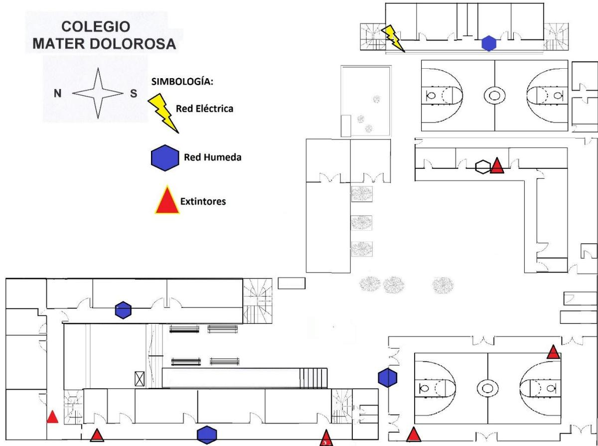
Planta Baja: Extintores, red húmeda y red eléctrica:
